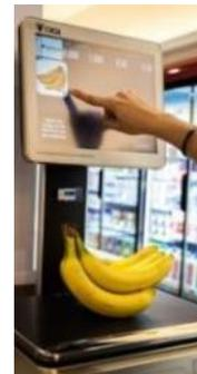
商品を自動的に判別できる高解像度のカメラを搭載した量り売り用の計量機を設置
